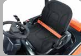
후드에 무릎 안쪽이 닿는 위치에 곡면 디자인 설계하여 편안함 후드를 라운드 설계하여 배터리 탈착 시 편리함
